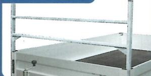
Feuerverzinktes Gestell für Befestigung von Gütern. In den Ecken montiert. Höhe 70 cm.
