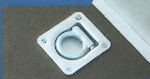
Versenkte Verzurrösen im Ladeboden. Wird auch für Aluminiumboden angeboten.
