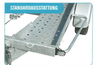
STANDARD AUSSTATTUNG Fahrradschutz für die Sicherheit. Kann auch für das Aufsteigen benutzt werden.
