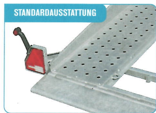
STANDARD AUSSTATTUNG Stahlboden mit nach oben gehenden Löchern. Stark und rutschfest.
